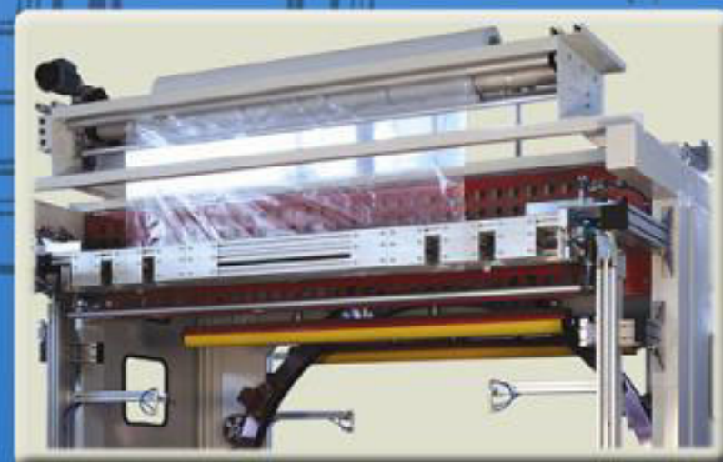
Sistema di copertura della testa e della coda del pacco Head and tail wrapping unit
