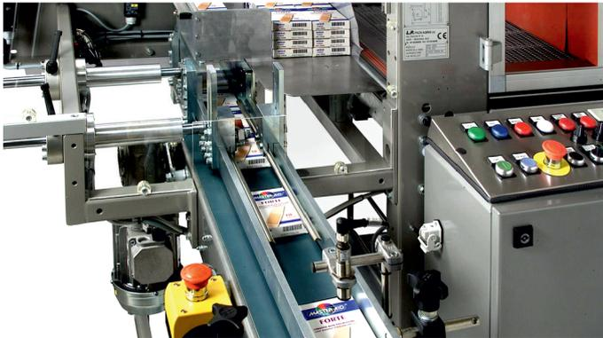
Versione con stratificatore per sacchetti a cuscino con possibilità di chiusura totale del pacco tramite saldatori laterali a punti. Indicata per alte velocità di produzione. (fino a 120 sacchetti/minuto)
